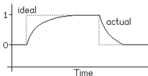
در شکل فوق، قسمت بالا رونده پالس بستگی به ولتاژ و جریان مدار و قسمت پایین رونده بستگی به المانهای ذخیره کننده انرژی دارد. اگر بتوان این انرژی را به سرعت از مدار خارج کرد، پالس خیلی سریعتر پایین می آید و به شکل ایده آل نزدیک تر می شود.
