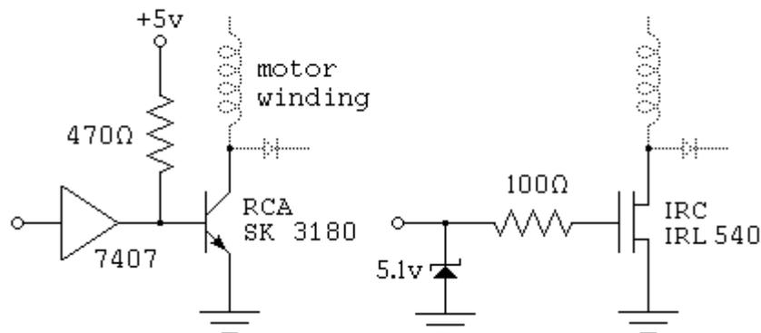
در مدار سمت چپ از یک جفت ترانزیستور که به صورت دارلینگتن (**Darlington**) بسته شده اند استفاده شده است. دارلینگتن **RCASK3180** بهره ای در حدود ۱۰۰۰ دارد، پس با فرض اینکه جریان تحریک بیس ترانزیستور حدود ۱۰ میلی آمپر باشد، می تواند جریانی حدود ۱۰ آمپر برای راه اندازی موتور تامین کند.
