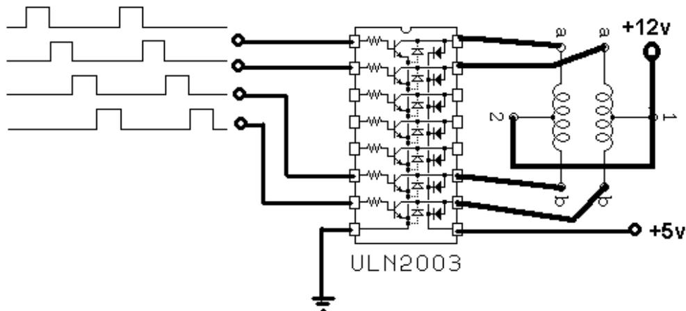
در صورتیکه جریان موتور از 300 میلی آمپر هم کمتر باشد می توان از **SN7541** هم استفاده کرد.
