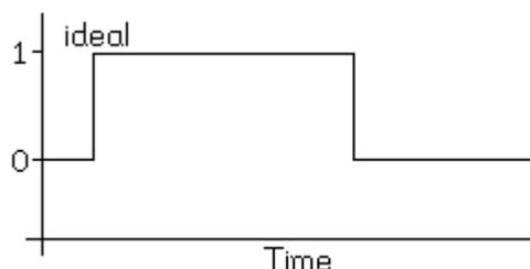
اما عملاً تولید چنین پالسی ممکن نیست، در عمل شکل پالس مربعی چیزی شبیه به شکل
