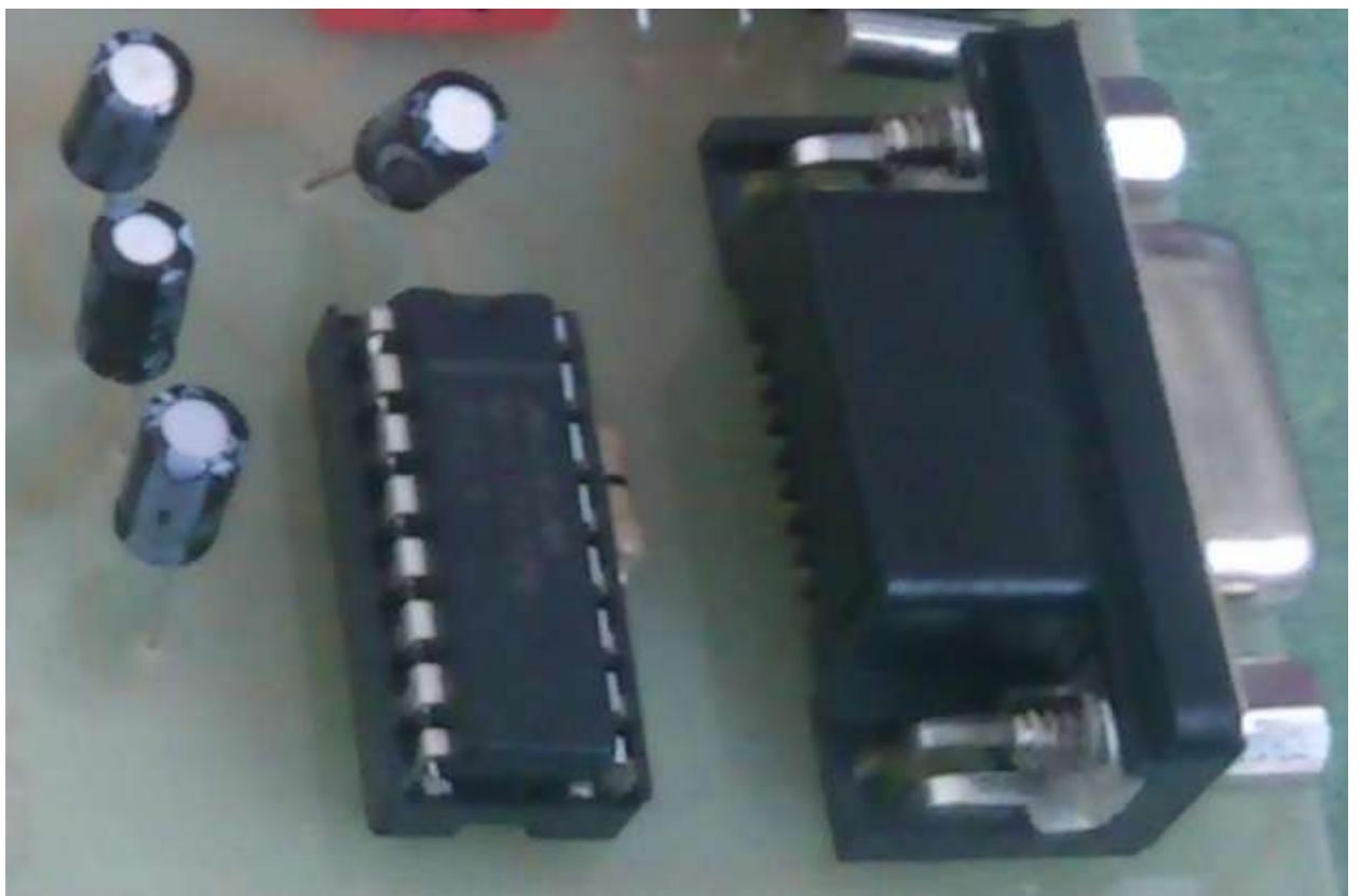
همانطور که می دانید برای تطبیق ولتاژ بین پورت سریال کامپیوتر و میکرو باید از تطبیق دهنده ولتاژ استفاده کرد که max232 یکی از این آی سی ها است.
